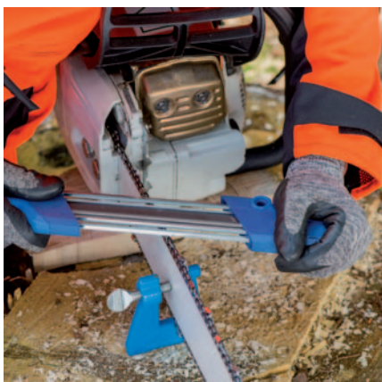
Passage de la denture droite à gauche par retournement de l'appareil.
