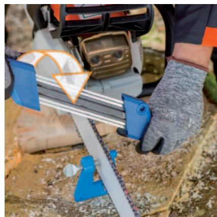
Passage de la denture droite à gauche par retournement de l'appareil.
