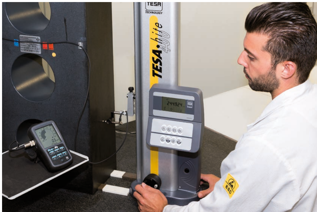
Mesure de perpendicularité avec palpeur inductif et afficheur TWIN-T10
