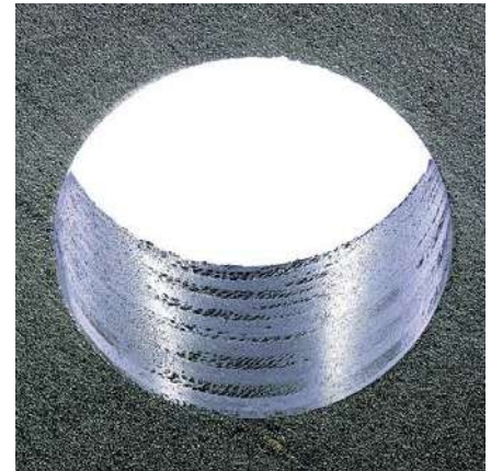
Bohrung D = 6,35 mm unidirectionales CFK mit optimaler Bearbeitungsqualität
