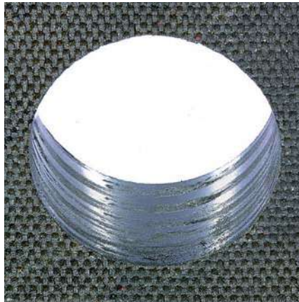
Bohrung D = 6,35 mm CFK mit Gewebedecklage, optimale Bearbeitungsqualität
