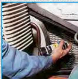
Dispersez ce spray incolore sur tous les types de courroies, bandes transporteuses, sangles, convoyeurs... Film anti-glissant incolore, propre, non-toxique qui augmente la durée de vie des courroies fatiguées ou lustrées en prévenant le patinage.
