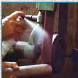
Lorsque vous travaillez des matières qui encrassent les meules, disques et bandes abrasives, il est très économique de déposer sur l'abrasif un très léger film qui empêche les adhérences. Nous insistons sur le fait que le film doit être très mince et ne doit, en aucun cas, mouiller l'abrasif. Cela serait du gaspillage.
