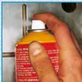
Le démoulant le plus souvent utilisé. Composition longue durée utilisée dans la plupart des cas d'injection, de coulée, soufflage ou extrusion de plastique. P.R. est extra-fin et laisse moins de traces et de marques que la plupart des films silicone connus.
