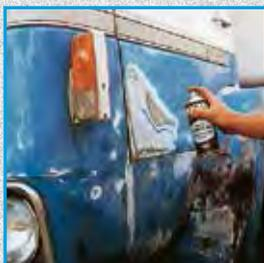
Il offre une protection cathodique durable contre la corrosion sur toutes les surfaces métalliques, p. ex. pour retoucher des pièces galvanisées à chaud. Il forme un film protecteur en paillettes de zinc d'une finesse microscopique qui sèche rapidement et adhère fortement.
