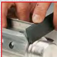
Des grains abrasifs carbure de silicium sont uniformément répartis dans une masse de caoutchouc synthétique.
