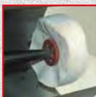
**Coton de polissage** à charger de pâte à polir en brique R 11/\*\* pour l'obtention d'un fini brillant sur toutes matières susceptibles d'être polies.
