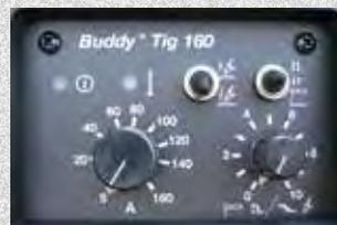
Le panneau de commande du Buddy™ Tig 160 est très simple à utiliser. Il ne compte que deux boutons de réglage : un pour le courant de soudage et un pour la pente de descente (en mode TIG) ou la force de l'arc (en mode MMA).
