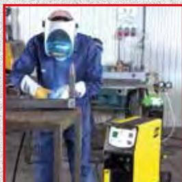
Origo™ Mag C201 est une source de courant de soudage monophasée, idéale pour l'utilisation du procédé MIG/MAG. Réglages simples par commutateur de tension et potentiomètre pour la vitesse de dévidage du fil. Un dévidoir intégré et le faible poids des machines en font des solutions pratiques pour les travaux courants en atelier ou en extérieur. Des machines garantissant d'excellents résultats et conçues pour des professionnels.
