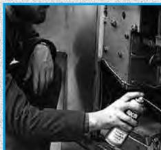
Ces sprays déposent un film lubrifiant mince mais tenace, repousseur de l'humidité, qui résiste très bien aux charges élevées sous toutes conditions difficiles. Formules très chargées en micro particules lubrifiantes qui pénètrent les maillons et lubrifient jusqu'aux axes. Une chaîne lubrifiée régulièrement ne s'allongera que très très peu !
