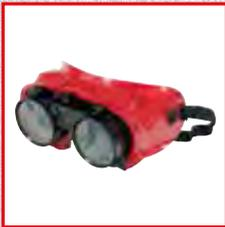
Masque de protection de teinte 5 pour le soudage au gaz, le coupage au gaz et le brasage. Ce masque est ventilé et les verres peuvent être relevés. Homologué CE selon la norme EN 166/EN 175.
