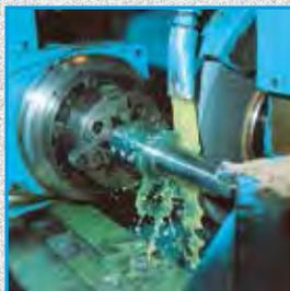
Lubrifiant synthétique concentré pour toutes rectifications plane, cylindrique et d'intérieur avec meules vitrifiées, diamant ou borazon. Aussi pour machine à bande abrasive avec arrosage.
