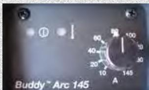
Buddy™ Arc 145 est très facile à utiliser avec un seul potentiomètre pour régler l'intensité de soudage.
