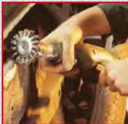
Ces brosses à mèches torsadées sont très étroites et particulièrement adaptées pour le brossage de longerons, dans les rainures, dans les angles. Les torsades évitent le dispersement des fils et augmentent l'agressivité de la brosse.
