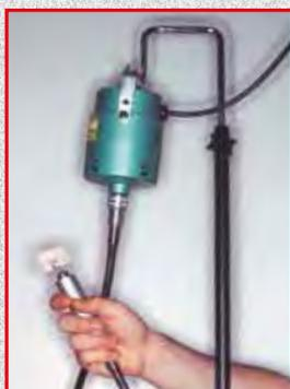
Dispositif à transmission flexible pour tous outils rotatifs à tige de max. 3 mm.
