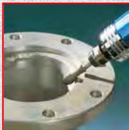
Les fraises en acier rapide J10 sont utilisées pour les travaux sur matières mi-dures et acier non trempés.
