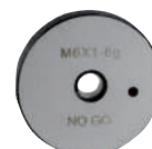
C : bague fileté n'entre pas
