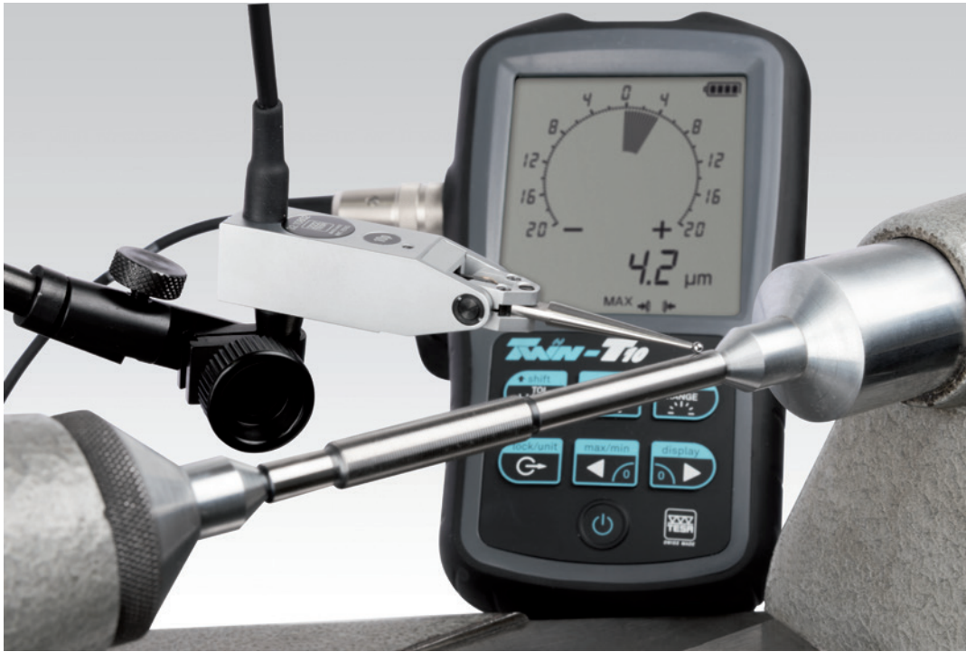
Mesure d'un battement avec TWIN-T10 et le palpeur à levier orientable GT 31
