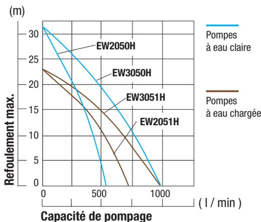
Le rotor et les parties d'étanchéité des pompes à eau chargée sont plus résistantes à l'abrasion que celles des pompes à eau claire.
