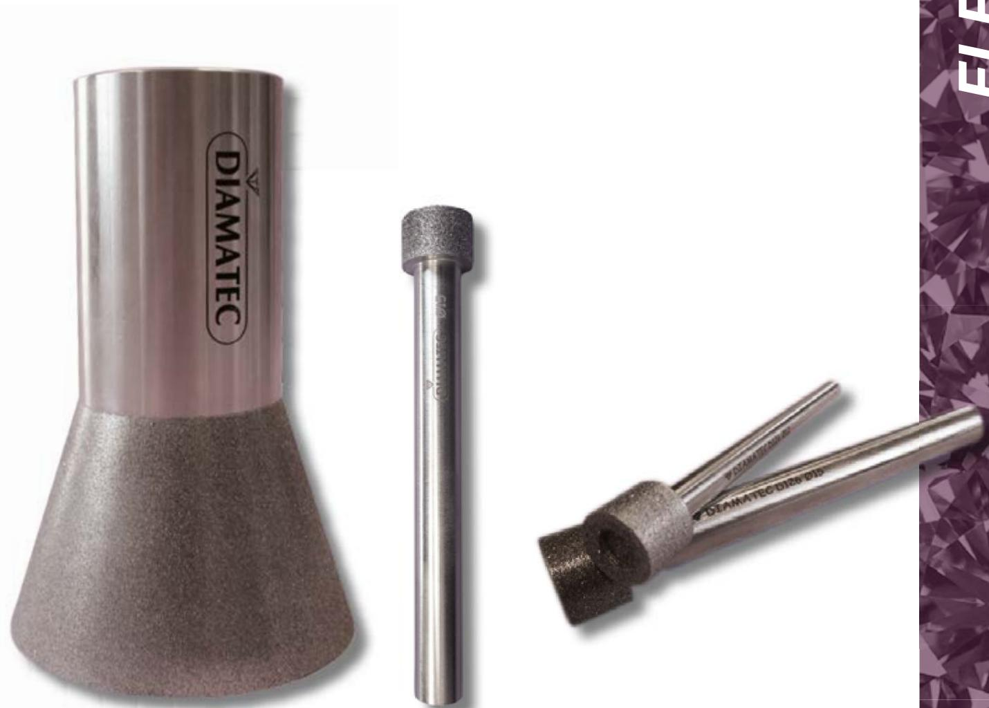
Les meules métal-céramique sont le plus souvent utilisées pour la fabrication de vos fraises carbures ou HSS monobloc. Ces outils permettent des prises de passes importantes tout en garantissant un état de surface adapté, sans déformation de la meule.
