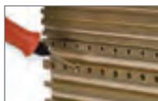
Cet outil mini est utilisé pour une super finition. Il inclut une lame triangulaire à 3 arrêtes extra fine et solide pour une super finition.
