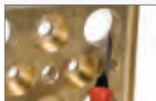
Ce set Scrape-Burr 42 contient une lame triangulaire permanente à 3 arrêtes pour une haute qualité de finition.
